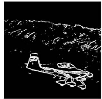
(d) Canny 算子的边缘提取 (d) Edge detection by Canny
